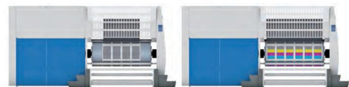
Die Maschinen der RotaJet 89-130-Serie basieren auf der gleichen RotaJet L-Plattform und können nachträglich vom Einfarbindruck mit 895 mm Papierbahnbreite (links) bis zum Vierfarbindruck mit 1.300 mm Bahnbreite aufgerüstet werden.
